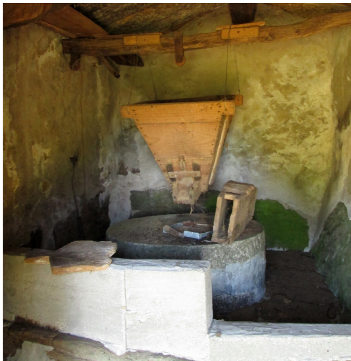
Figura 49. Dispositivo de moagem em madeira com forma de pirâmide invertida
